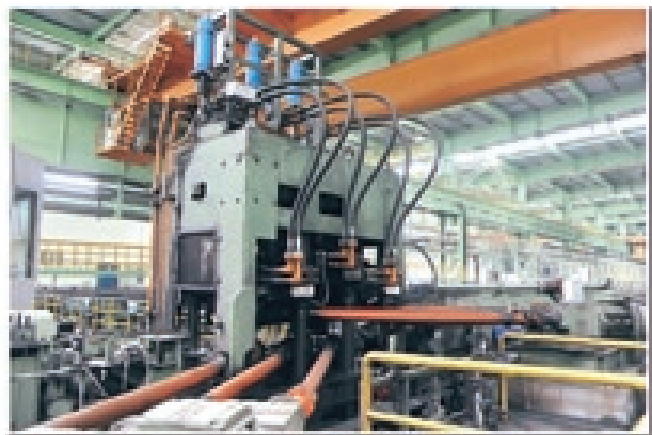
\Phi 159\text{mm} 高压锅炉管光亮热处理线 \Phi 159\text{mm} bright heat treatment lines for HP boiler pipe
